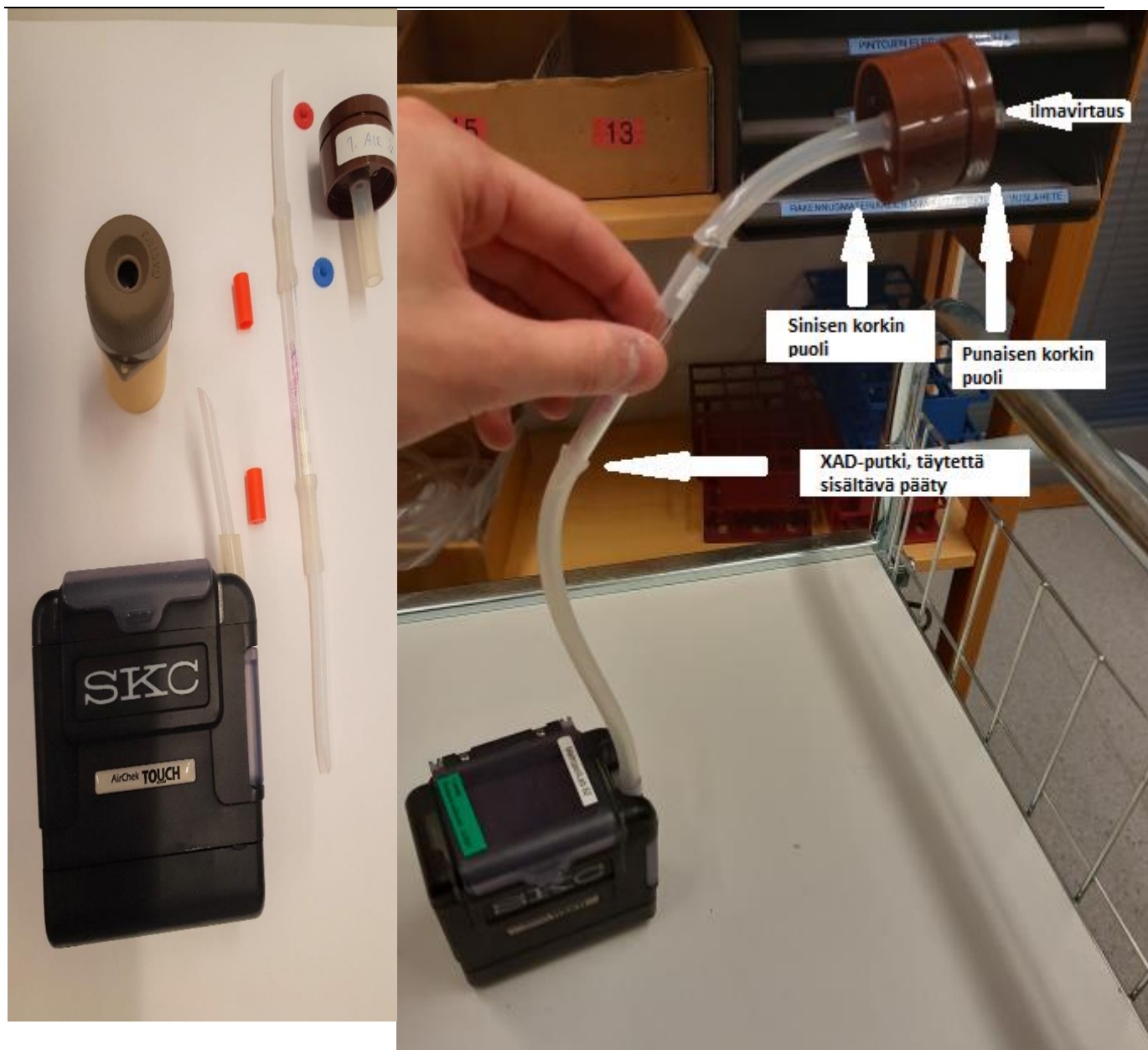
KUVA 1: Vasemmalla puolella PAH-näytteenottovälineet: pumppu, letkut, XAD-putki, filterikeräin, rasia XAD-putken päiden avaamiseen ja korkit XAD-putken sulkemiseksi näytteenoton jälkeen. Oikealla koottu välineistö kaasumaisten ja pölyyn sitoutuneiden PAH-yhdisteiden saman aikaiseen näytteenottoon.
